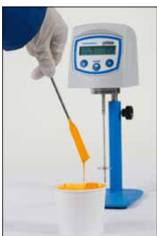
Ruční test: Viskozita/rychlost protékání
