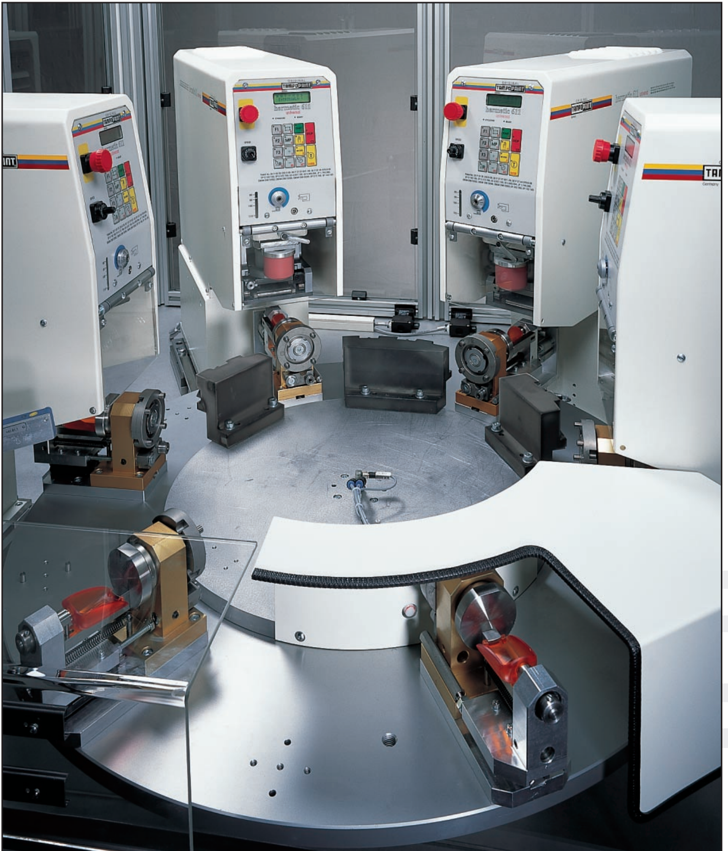
Modul 2000 mit 4 Hermetic 6-11 und drehbaren Werkstückaufnahmen
